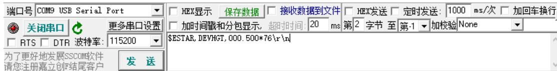
图 6-3 通过串口配置设备安装高度
