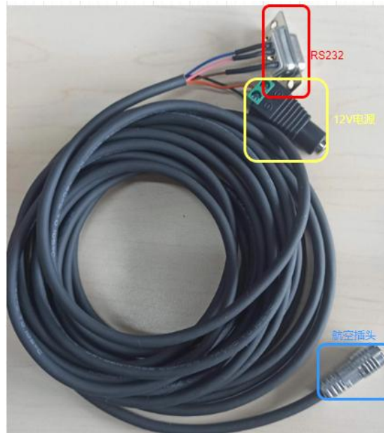
图 6-1 设备航插转接线的连接
